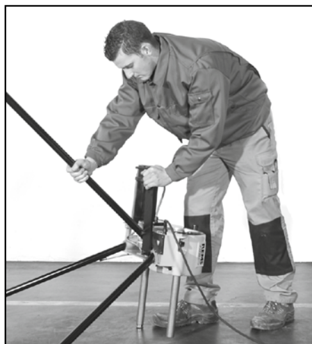
Fig. 1: Rohrfüße einstecken Fig. 1: Inserting the tubular legs Fig. 1: Engager les pieds tubulaires Fig. 1: Infilare le gambe di supporto Fig. 1: Introducir las patas tubulares Fig. 1: Steunpoten insteken Fig. 1: Isättning av benen Fig. 1: Montering av rørben Fig. 1: Indstikning af rørben Kuva 1: Putkijalkojen asennus Fig. 1: Introduzir os pés tubulares Rys. 1: Montaż nóżek rurkowych Obr. 1: Trubkové nohy nastrčit Obr. 1: Růrkové nohy nastrčit 1. ábra: Feltolni a csőlábakat Sl. 1: Utaknuti noge od cijevi Slika 1: Vstavite cevno podnožje Fig. 1: Introducerea picioarelor tubulare Фиг. 1: Вставить трубные ножки Εικ. 1: Τοποθέτηση των σωληνωτών ποδιών Resim 1: Boru tipi ayakların takılması Фиг. 1: Поставяне на тръбните стойки 1 pav.: Vamzdinių kojų įstatymas Att. 1: Ievietot caurules galus Joonis 1: Torujalgade sissepanek
